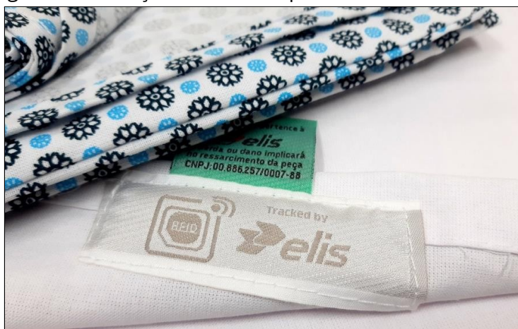
Figura 3: Marcação de enxoval por meio do sistema RFID
