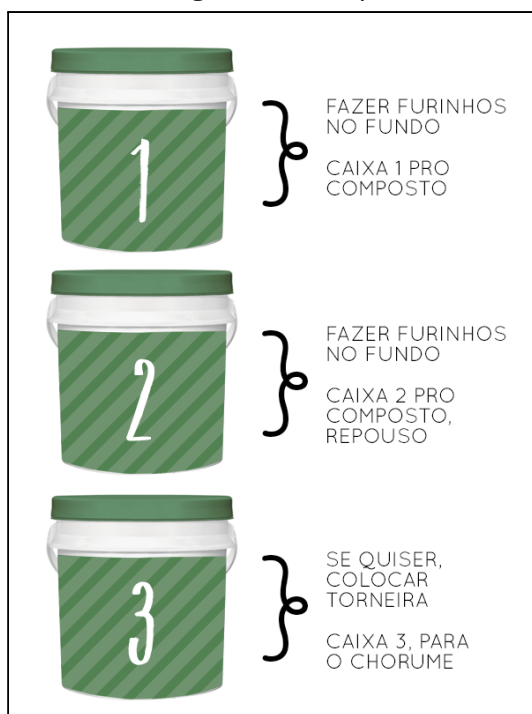
Figura 7 - Esquema de montagem de composteira doméstica com baldes
